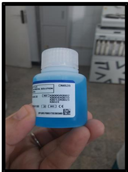
Figure 25. Tampon de démasquage (TRS)
