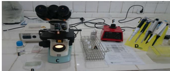
Figure 18 : Matériels nécessaire pour le comptage des cellules.
