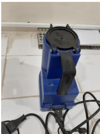
Figure 13 : Décongélateur de Paillettes. (IMV-Technologies, Aigles, France)
