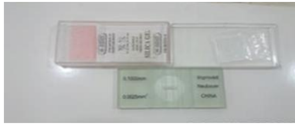
Figure 17 : Photo de la cellule de Neubauer.
