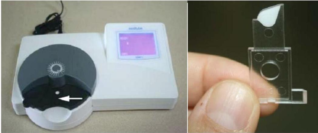
**Figure 7:** photomètre Mini tube avec cuvette remplie en sperme (John Dascanio. 2014).
