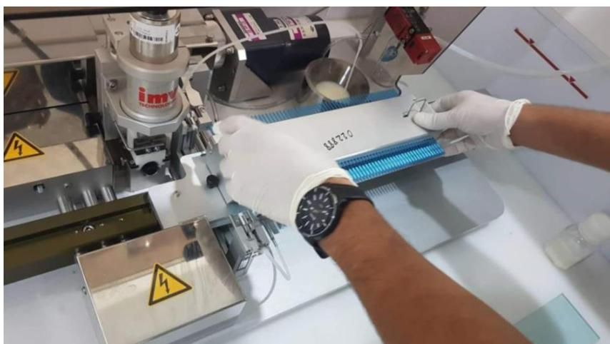
**Figure 13: Machine à remplir et a souder MRS I, IMV-Technologies**
