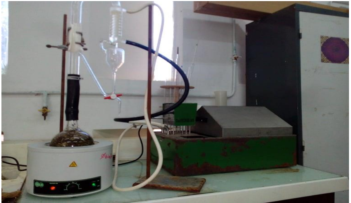
Figure 24 : Matériel d'hydrodistillation employé pour l'extraction de l'huile essentielle de laurus nobilis .
