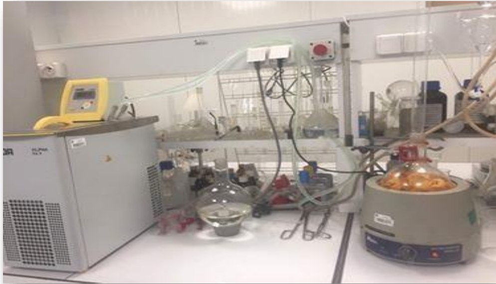
Figure10. Dispositif d'hydrodistillation utilisé à l'échelle du laboratoire
