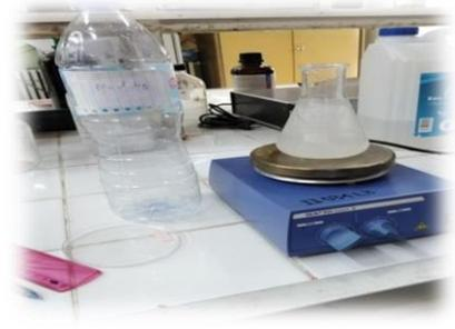
**Figure 15 :** Préparation de la solution de NaCl à 5% (original 2020)
