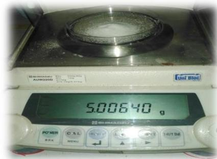
**Figure 13 :** Pesée du KCl avec la balance analytique
