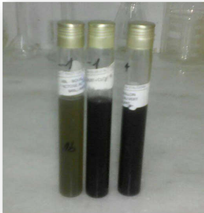
Figure 3.4. Noircissement du milieu Giolitti Cantoni après incubation (photo originale, 2017).
