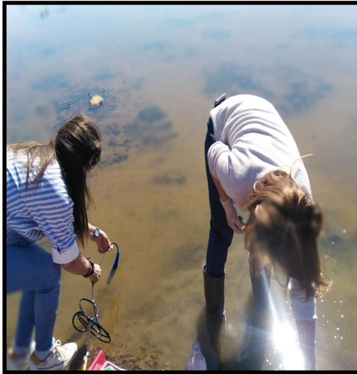
**Figure 21** : La mesure de pH de l'eau par un pH- mètres (la présente étude).
