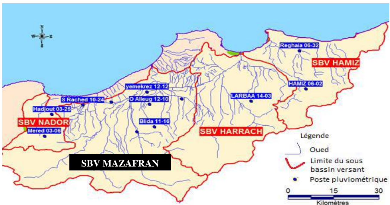
Fig20 : Chevelu hydrographique et stations pluviométriques
