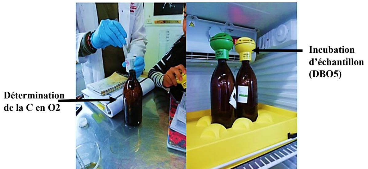
Fig 06 : protocole de dosage de la DBO5 au laboratoire.
