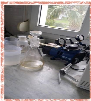
Rampe de filtration sous vide
