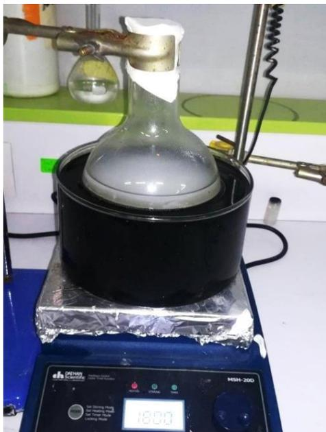
Figure 22. Cristallisation du gel résultant
