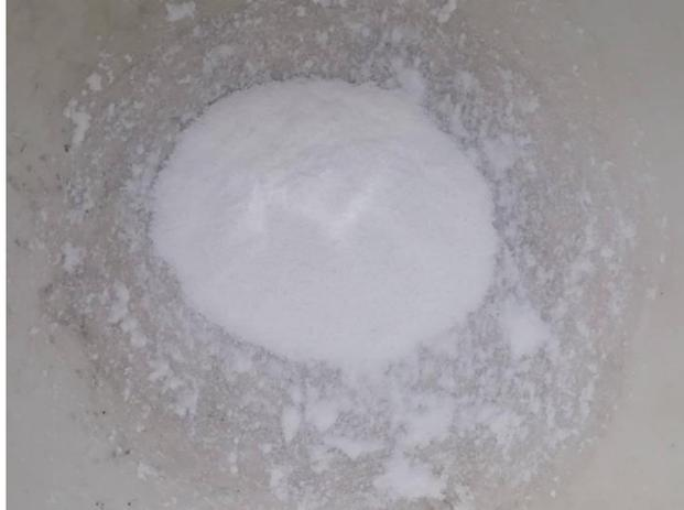
**Figure 25. Produit final après broyage Mg-Al HDL**
