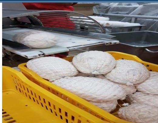
**Figure n°14 :** Conditionnement (mise le produit au boyau alimentaire)
