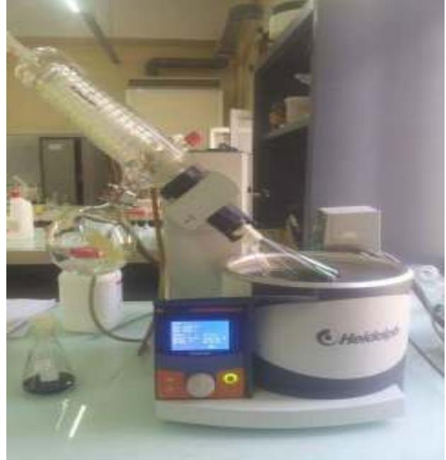
**Figure18 :** Appareil d'Evaporateurrotatif
