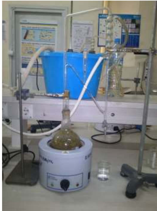
Figure 3. Dispositif d'extraction d'HE de type clevenger (photo originale, 2017).
