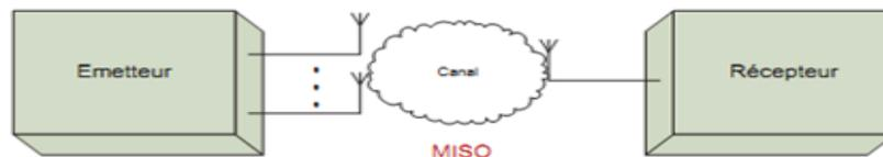
**Figure 4.32 : schéma représentatif du modèle MISO.**
