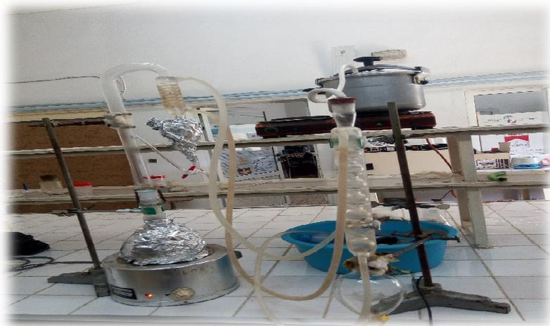
Figure 18 : Montage de l'hydro-distillation
