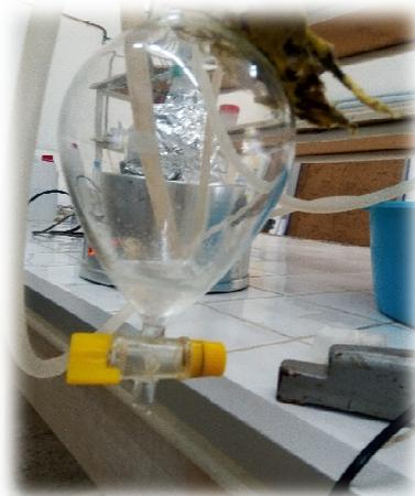
ampoule à décanté
