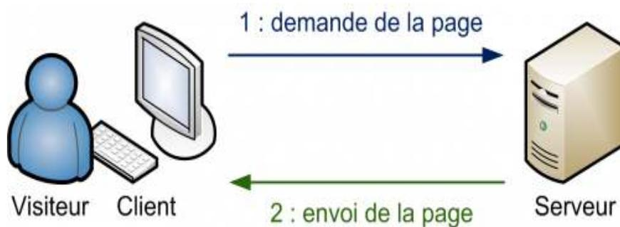
*Figure 1-04* : « Communication entre le serveur et le client –cas de site statique »
