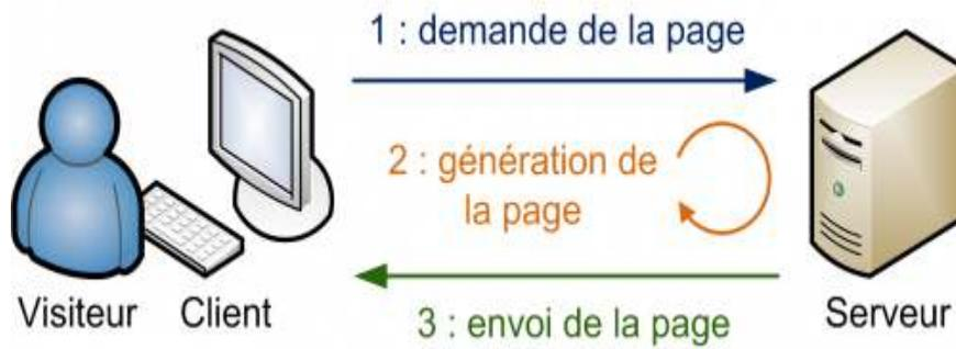
Figure 1-05 : « Communication entre le serveur et le client –cas de site dynamique »
