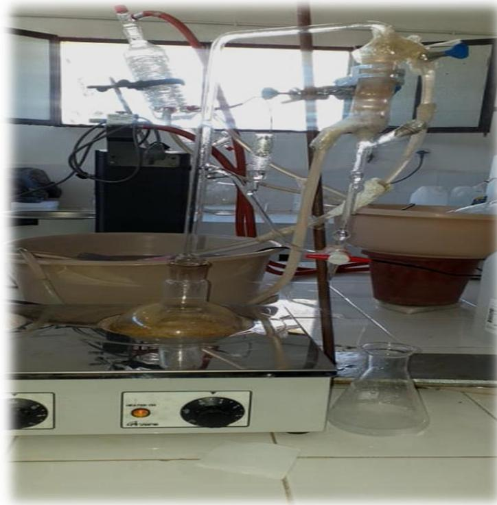
**Figure 06:** Montage d'hydrodistillation.
