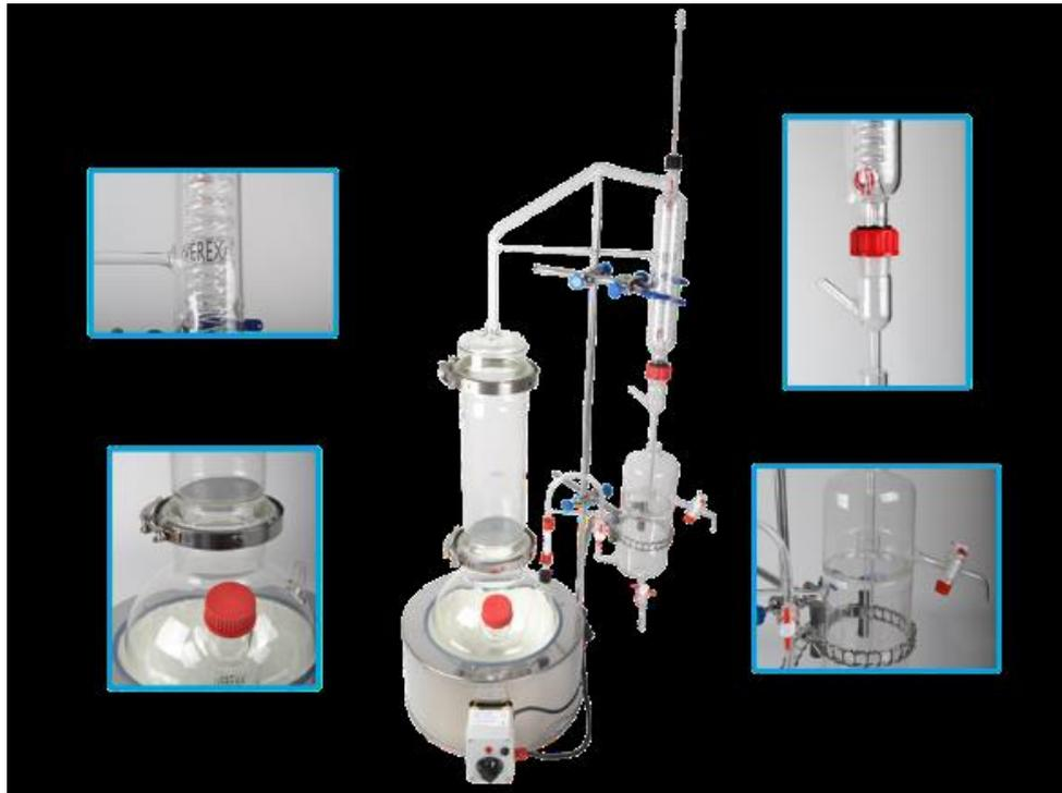
**Figure 04:** Appareil de type Clevenger, répondant aux exigences et aux normes de la pharmacopée européenne. (DUMAS, 2015)
