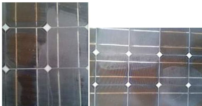
Figure IV.11 : La délamination (UDTS)
