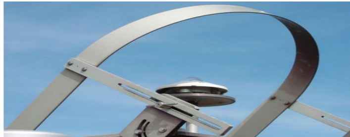
Figure I.4 l'instrument qui mesure le rayonnement diffus [9]
