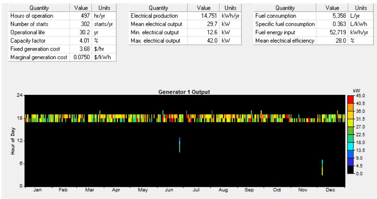
Figure A.18 : Energie produite par le groupe diesel.
