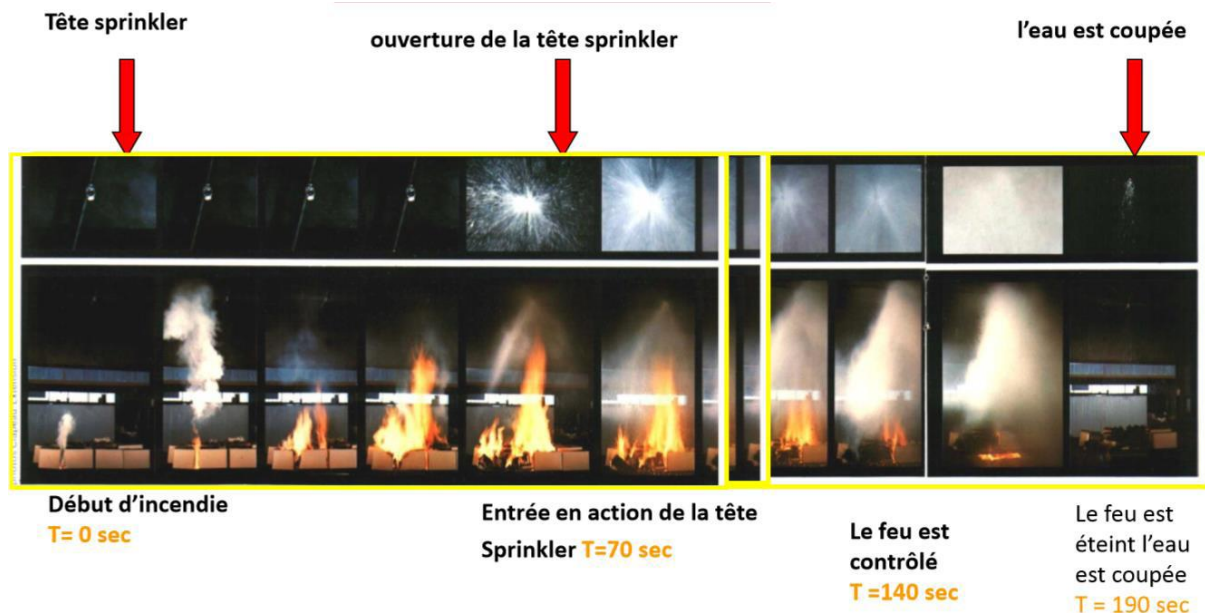
FIGURE 140: tête d'extinction automatique sprinkler. Source : site web : //www.google.dz/
