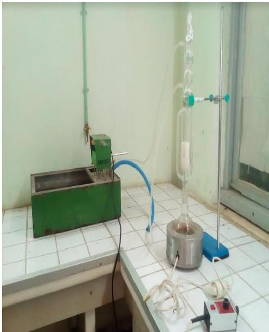
Montage de l'extraction par Soxhlet
