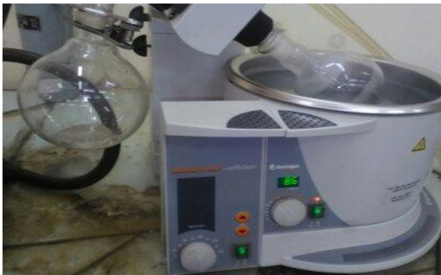
Figure 8 : Récupération de l'hydrolat par rota-vapeur (2019)
