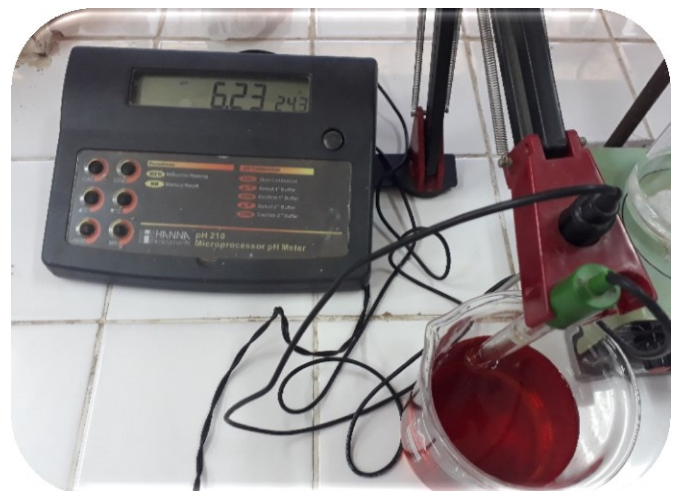
Figure 24 : Contrôle de pH, de la conductivité électrique est obligatoire avant chaque utilisation.
