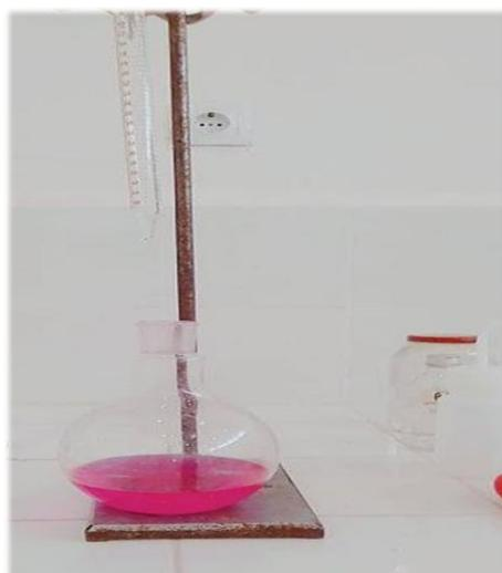
**Figure 58:** La mesure d'acidité titrable de gel d'*Aloe vera*
