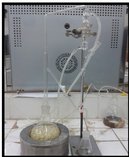
Figure 17 : Matériel (Clévenger) d'hydro-distillation employé pour l'extraction de l'huile essentielle de l'ail
