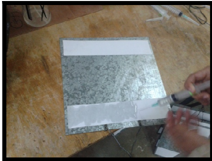
Figure 18 : Disposition de lanières en papier buvard portant le traitement, sur les langes graissées.
