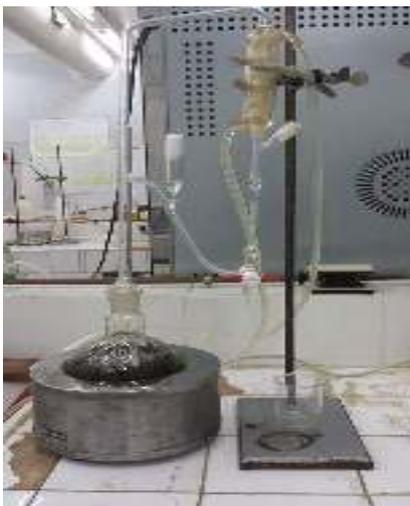
**Figure09:** Extraction par hydrodistillation
