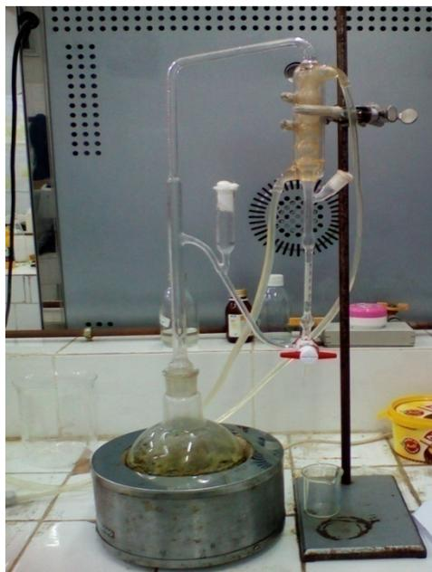
distillation jusqu'à l'obtention (**figure11**). La récupération la lecture du rendement à graduée attaché à l'appareil.
