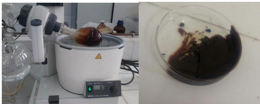
Figure 10 : Evaporation des deux échantillons par un Rota vapeur, et l'extrait obtenu après l'évaporation ( originale 2017 )
