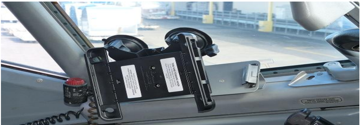
Figure II.1 : Ventouse de fixation de l'EFB
