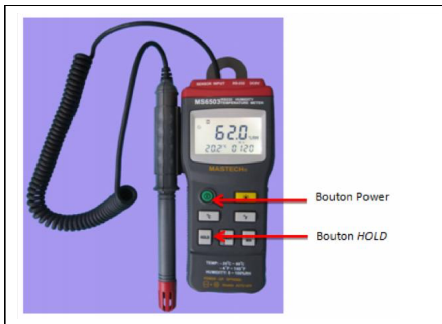
FIGURE 5.17 – Vue du capteur MS6503 avec les 2 principaux boutons à manipuler (Power et Hold).
