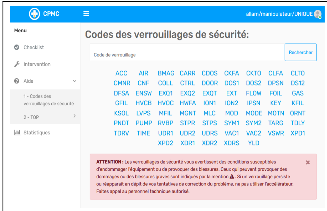
FIGURE 5.9 – Page de Codes des verrouillages (anomalies)
