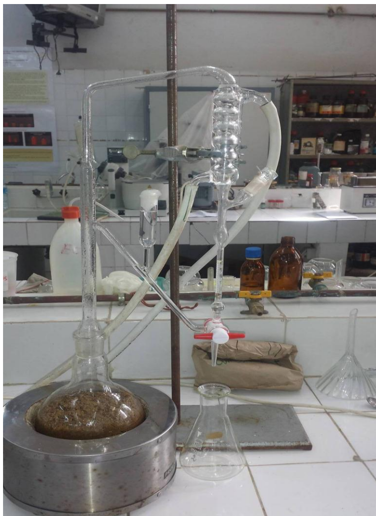
Figure 10: Dispositif d'extraction par hydrodistillation
