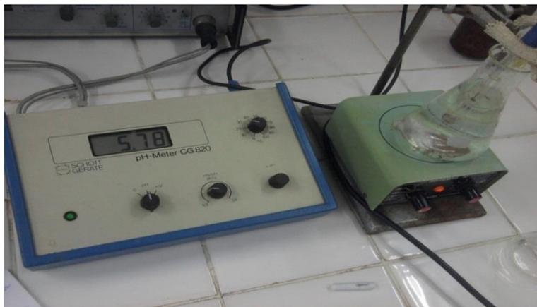
**Figure n°15** : Mesure du pH avec le pH mètre.
