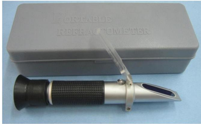
**Figure n°19 : Réfractomètre.**
