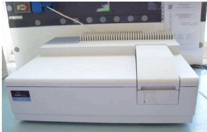
**Figure 2: Spectrophotomètre UV/Visible**
