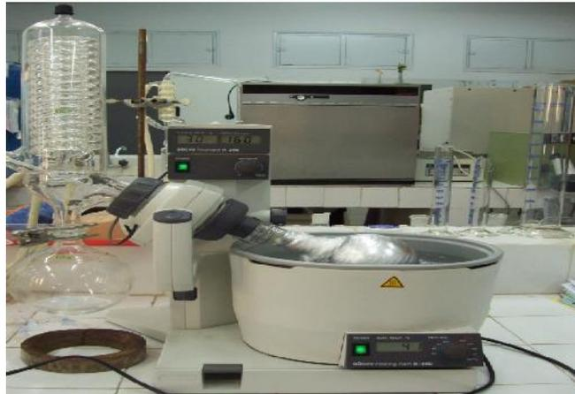
**Figure 1 : Evaporateur rotatif**
