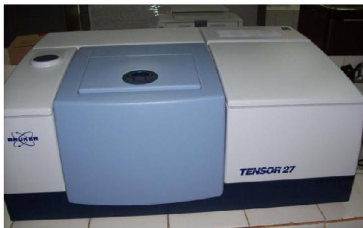
**Figure 3 : Spectromètre Infra Rouge à Transformer de Fourier (FTIR).**
