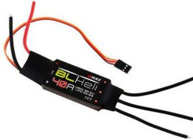
Figure 1.10 : Contrôleur de vitesse ESC.
