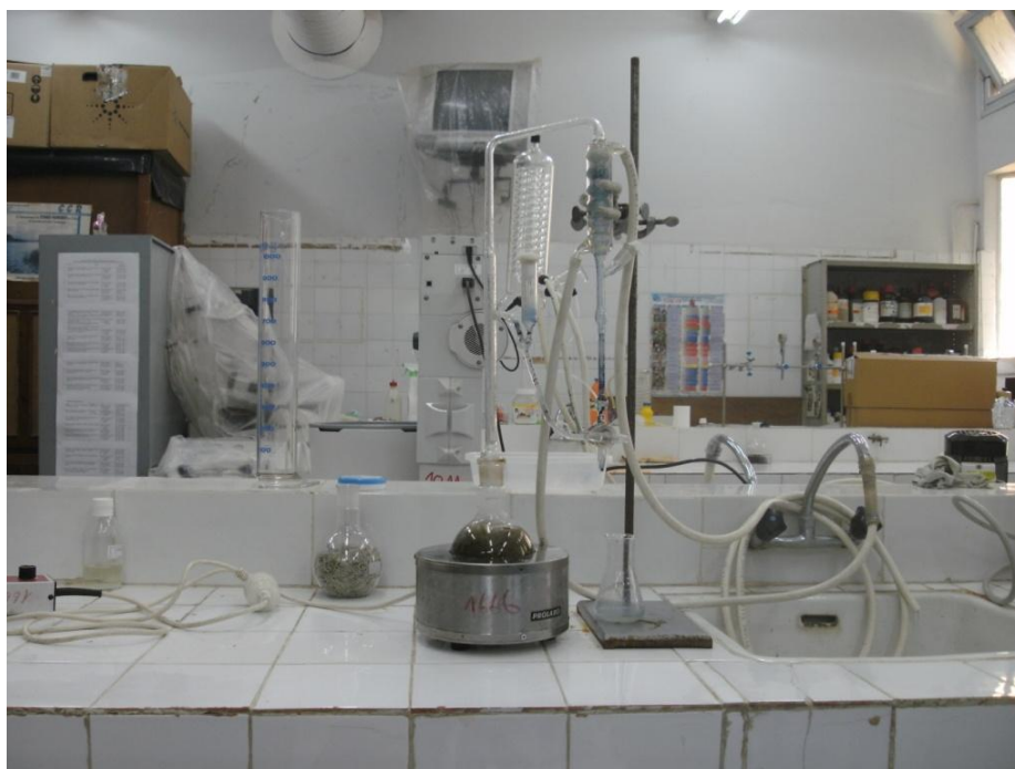
Figure 06 : Dispositif d'extraction par hydrodistillation
