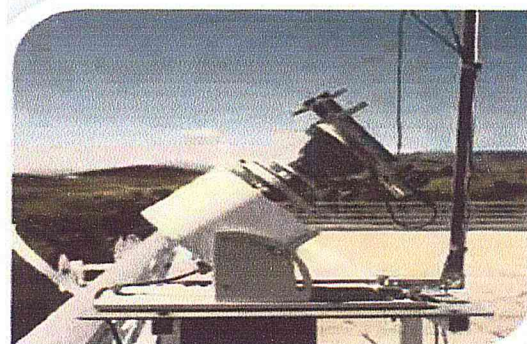
Figure I.13:Pyrhéliomètre pour la mesure d'irradiation directe [7]
