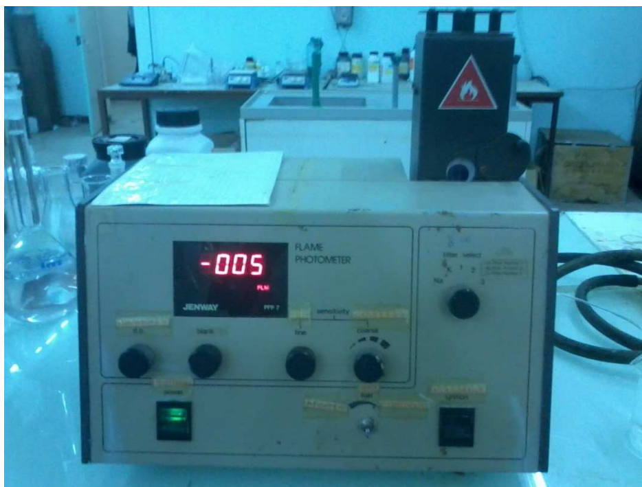
Figure 14 : spectromètre d'émission à flamme de type Jenway pfp 7.
