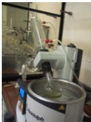
Fig. N°20 : Évaporateur rotatif.
