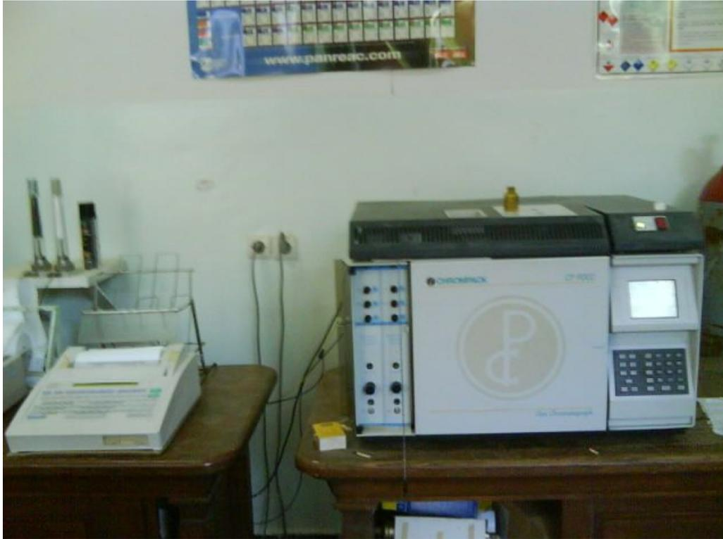
**Fig. N° 26** : chromatographie phase gazeuse .
