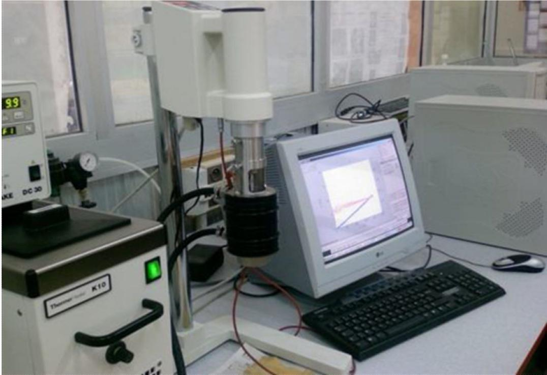
**Fig. N°24:** Viscosimètre Thermo HAAKE VT 550.
