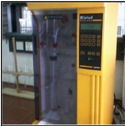
Distillateur de protéines
