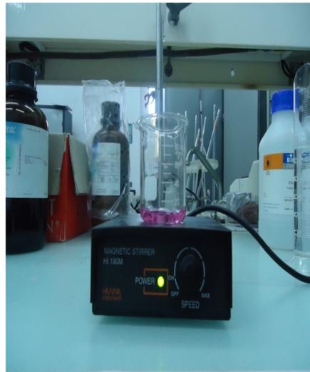
**Figure :** La réaction pour la détermination de l'acidité
