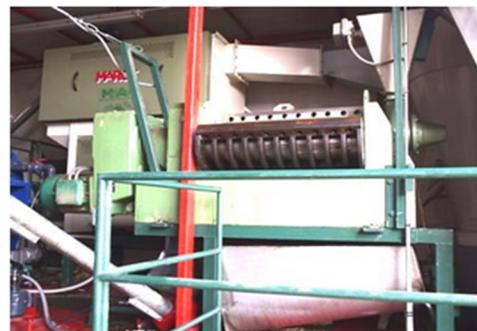
**Figure 4** : les presses à barreaux
