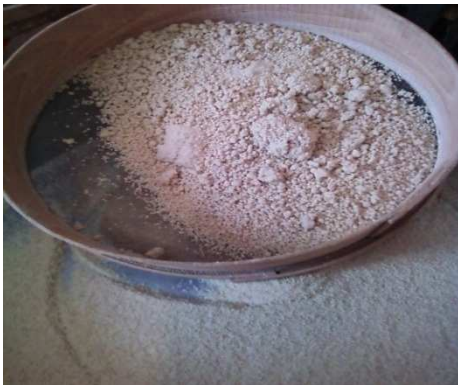
Photos 11 : Calibrage sur TK1 avec une légère pression
