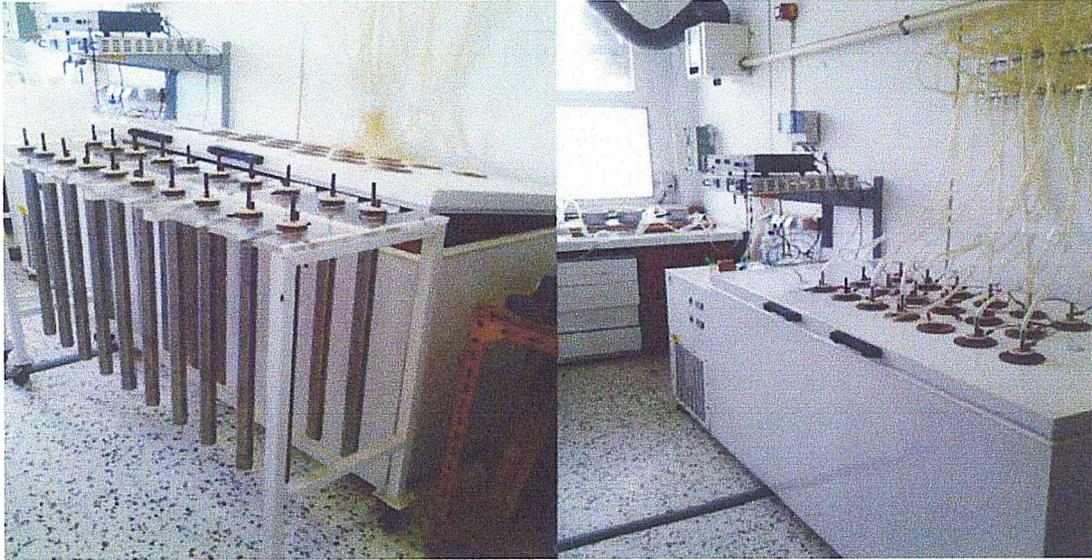
Fig. IV. 8 : Les cellules d'enrichissement électrolytique
