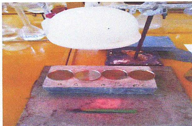
Fig. III. 18 : Séchage des échantillons sous lampe infra-rouge
