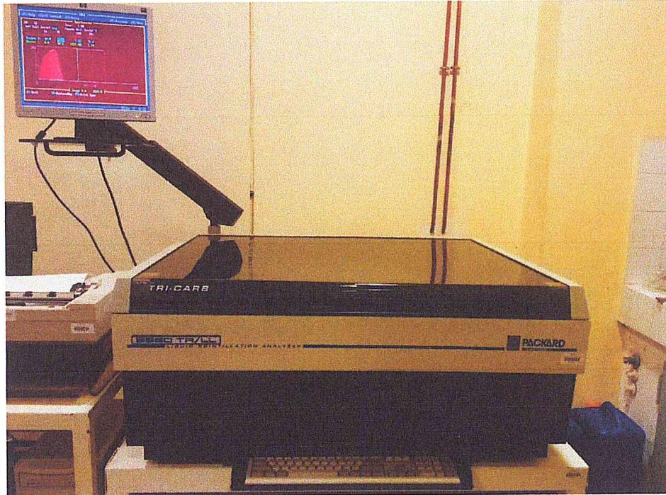
Fig. IV. 11 : L'appareillage de mesure de la scintillation liquide Tr-iCarb
