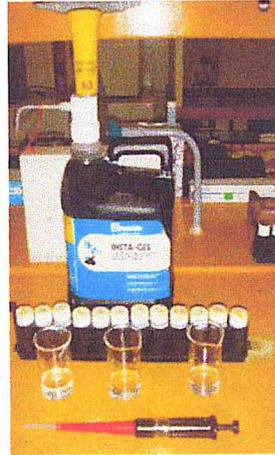
Fig. IV. 10 : Flacon contenant le liquide scintillant
