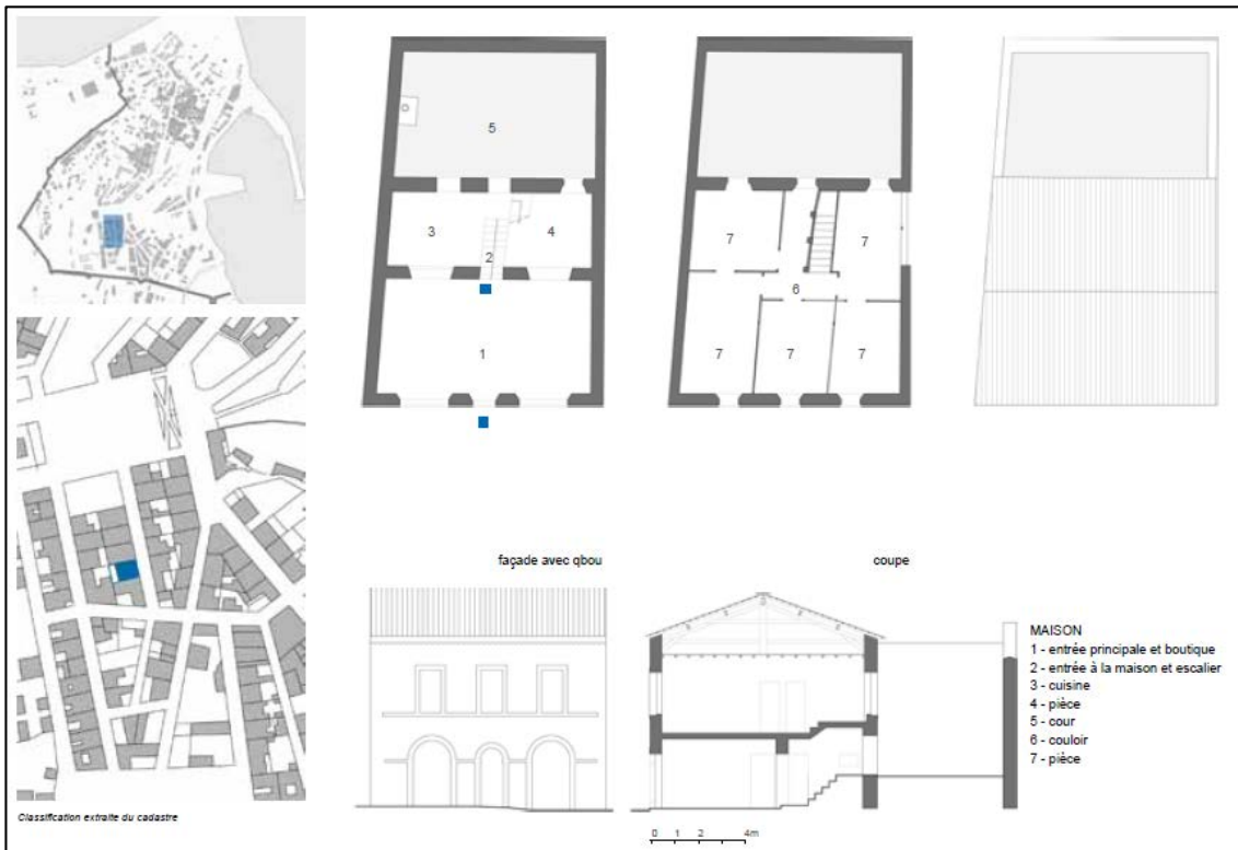
Figure 77 : Maison restaurée en relation avec la RN24 avant l'intervention.
