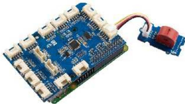
**Figure III.13 :** Branchement du capteur d'électricité avec le Raspberry pi.
