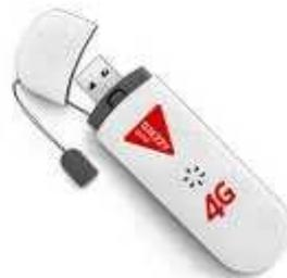
**Figure II.22 :**Clé 4G/GSM.
