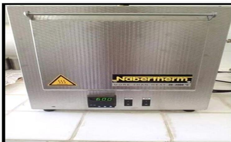
**Figure 22 : une photo de four a moufle (original ; 2020)**
