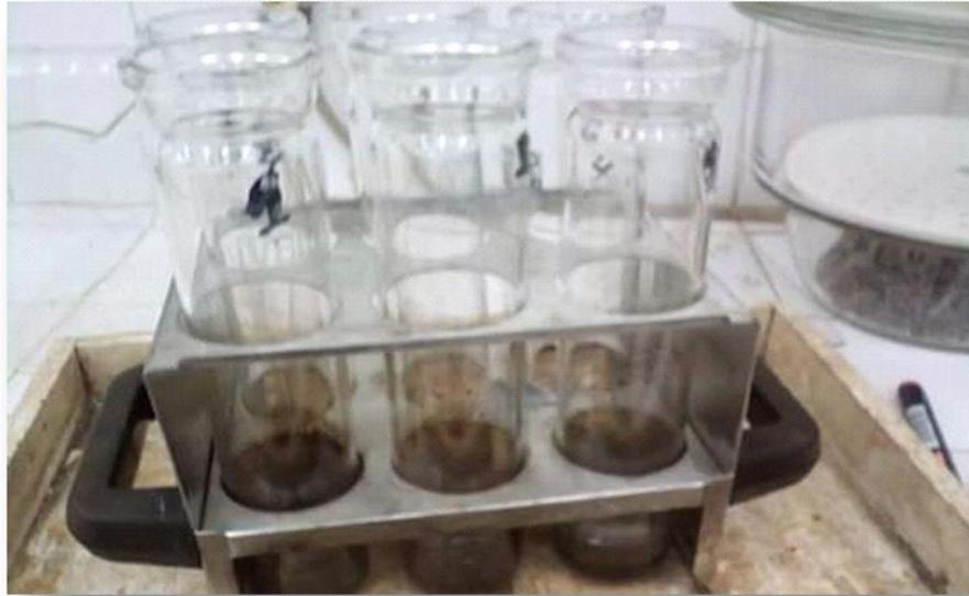
**Figure 29 : les Solutions dans les matras de kjeldahl (original ,2020)**
