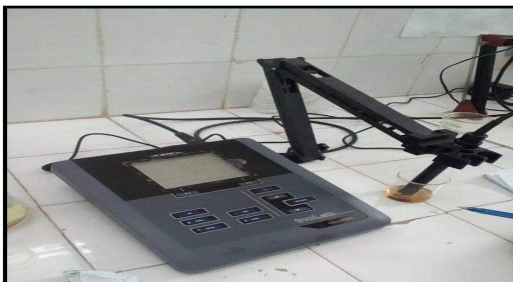
**Figure 28 : l'analyse de la conductivité électrique par le conductimètre (original ; 2020)**
