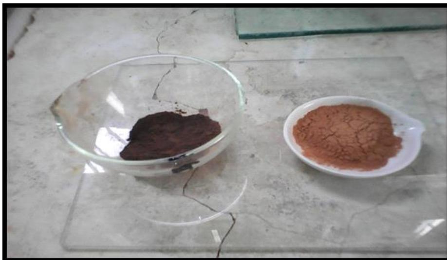
**Figure 24 : un échantillon de la litière avant et après la sortie de four a moufle (original ; 2020)**
