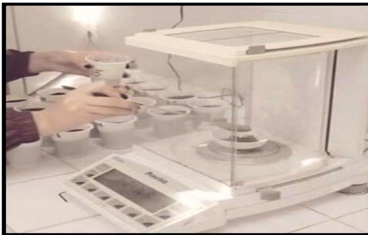
**Figure 21 : Une balance a précision pour peser les échantillons (original ; 2020)**
