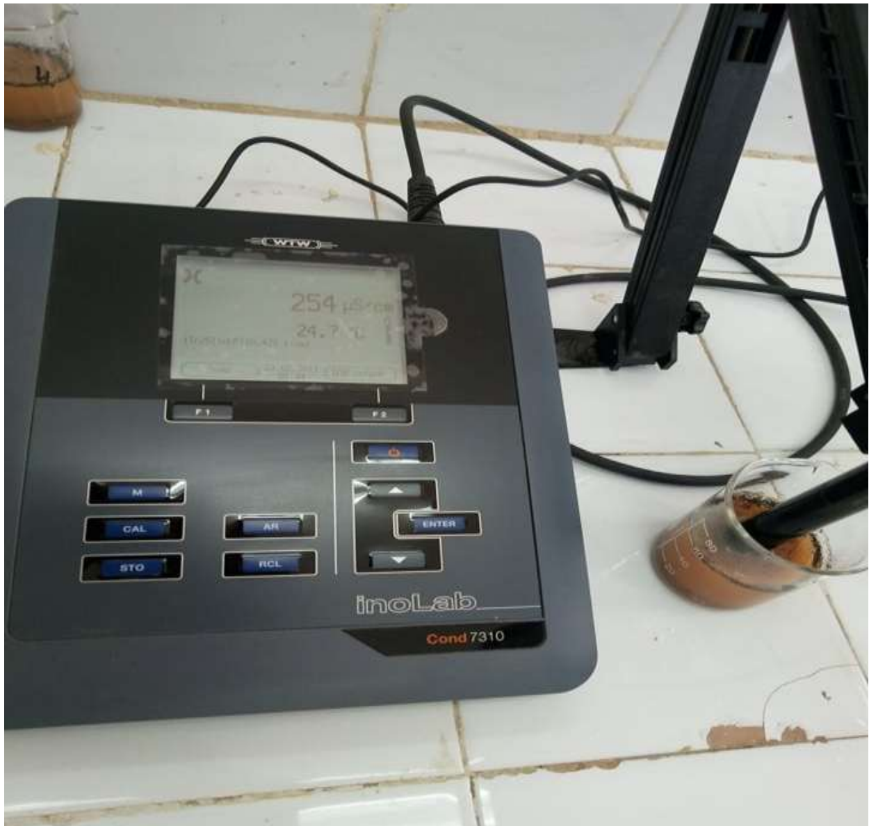
Figure 17 : L'analyse de conductimètre électrique au niveau de l'INRF
