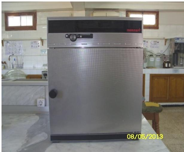
Figure 12 ♦ Etuve de séchage réglée à 103°C
