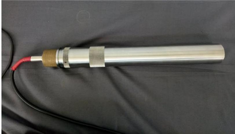
**Figure II . 8:** détecteur sonde, un scintillateur NaI(Tl)
