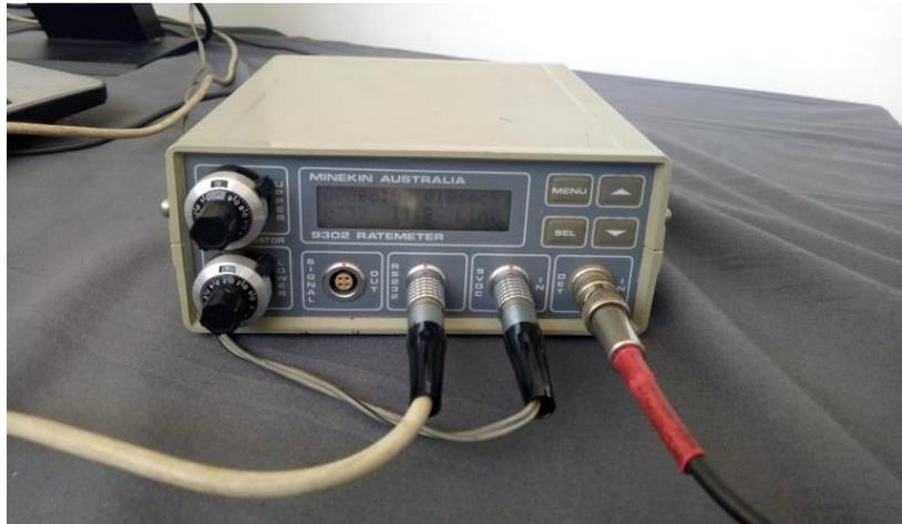
Figure II . 9: Le Right Meter utilisé pour le comptage des rayonnements détectés
