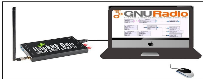
Figure III.10 : La liaison GNURADIO et HACKRF One.
