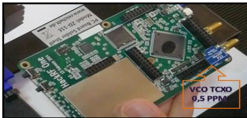
Figure III.8 : l'emplacement du VCO TCXO 0.5 ppm sur le HackRF.
